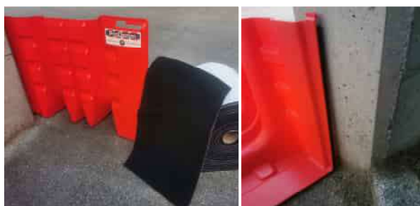
Anbindung an Vorsprung mit geradem Modul Abdichtung mit DichtFit zwischen Mauerwerk und Modul
